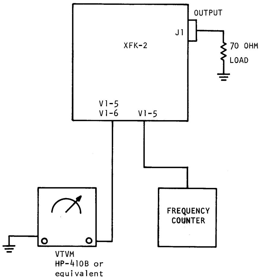
TEST II 200KC OSCILLATOR TEST
