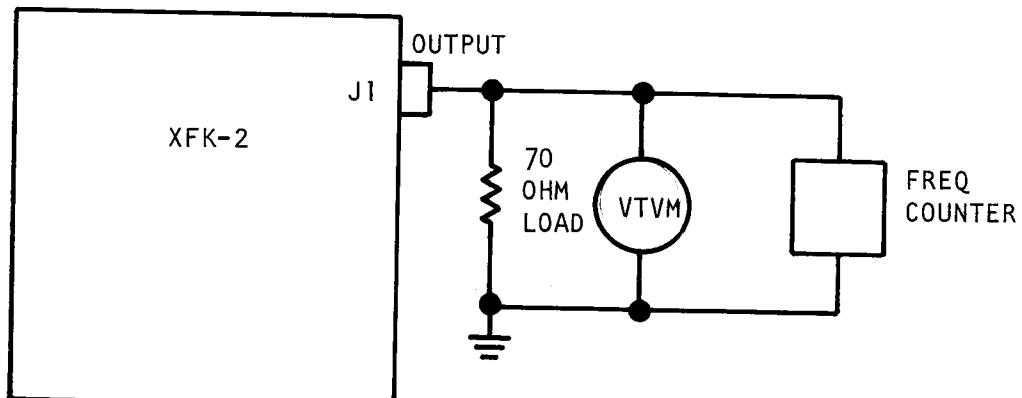
TEST II RF ALIGNMENT BAND 1
