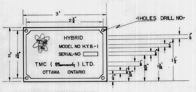
ENGRAVING TO BE GENTERED AND EQUALLY SPACED.
